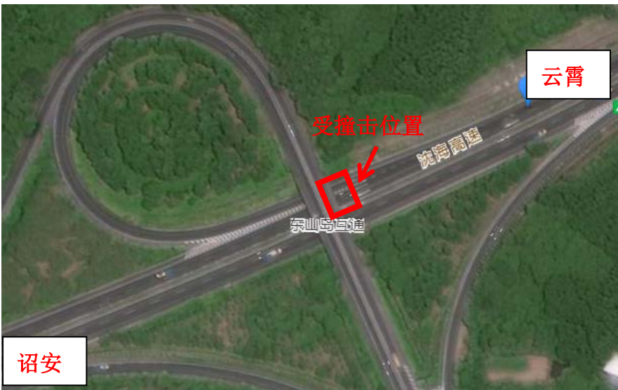
图1-2: 林头互通1#桥受碰撞位置示意图
